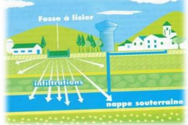
Figure. Contamination des eaux souterraines par une fosse à lisier fissurée
